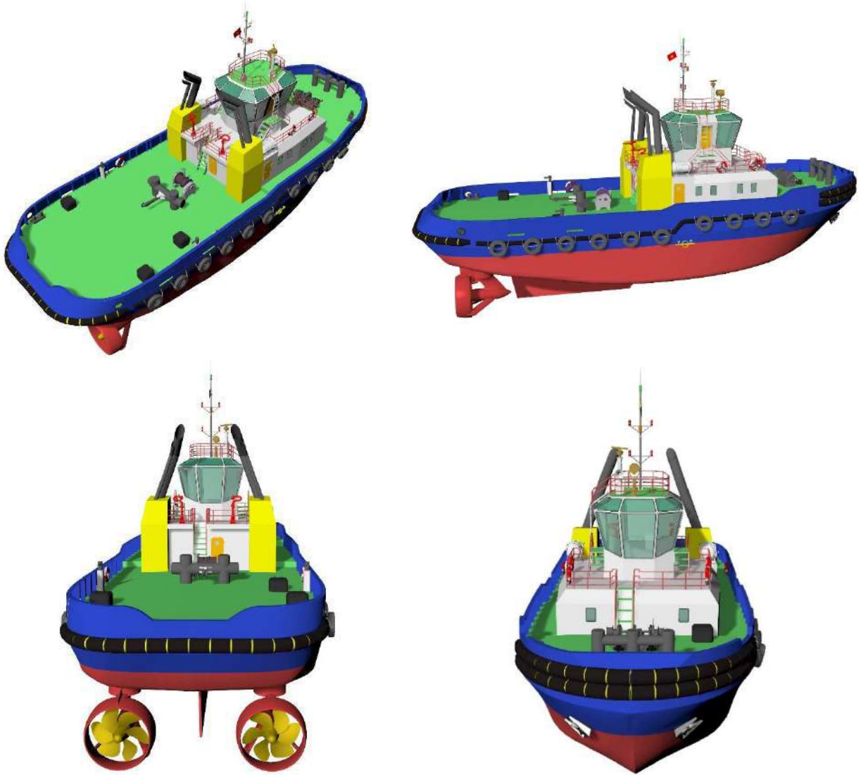
Phôi cảnh 3D bố trí chung tàu lai Azimuth của Công ty cổ phần Lai dất và Vận tải cảng Hải Phòng
