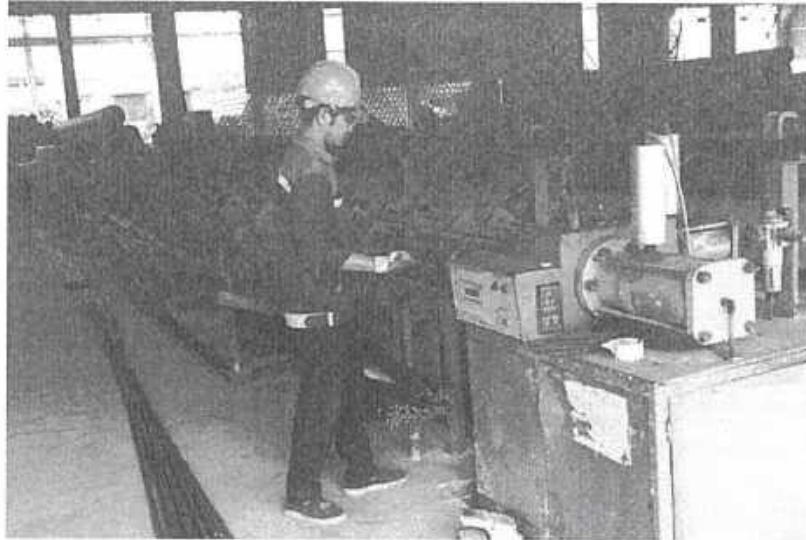
Cốt thép đai được kéo thẳng bằng tời, cắt bằng kim cộng lực theo đúng kích thước thiết kế.
